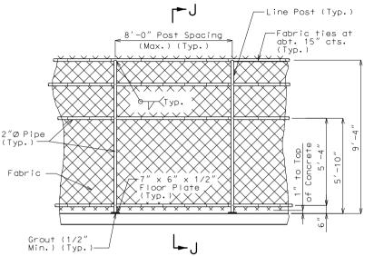
ELEVATION SHOWING POST SPACING
